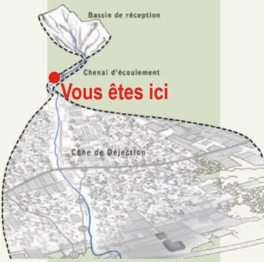
Vous êtes ici dans le chenal d'écoulement du Manival, dans une des rares parties de son lit qui n'est pas équipée de seuils de correction torrentielle. C'est une zone de transport des matériaux en perpétuelle remaniement : les variations de hauteur du fond de son lit peuvent aller couramment de 1 à 2 mètres... et parfois jusqu'à 3 à 4 mètres ! On dit qu'il respire... On peut observer, dans ce secteur, des dépôts de matériaux issus de phénomènes de charriage et de laves torrentielles.
