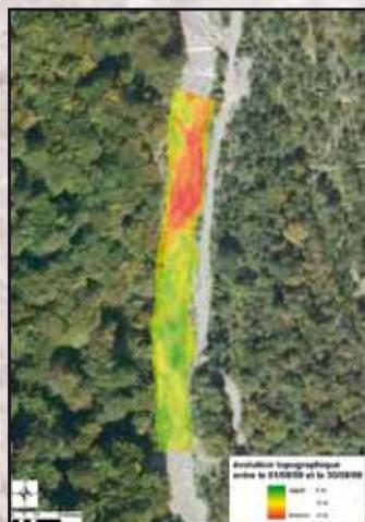
Reconstitution des dépôts et des reprises sur un tronçon du Manival à partir d'acquisition LiDAR terrestre
