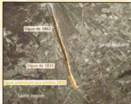
Traces approximatives des digues construites en 1831 et 1862. La première mesurait 285 m de long et 2,30 m de hauteur. La seconde environ 400 m de long. Il existait déjà auparavant une digue d'environ 300 mètres qui avait bien résisté à la crue de 1831 à l'amont de la route et sans doute d'autres anciens tronçons.
