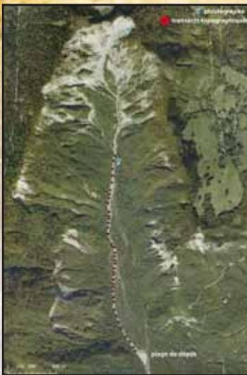
Dispositif de mesure du Manival ; en vert : emplacement des 39 profils en travers pour le suivi topographique du chenal principal ;
