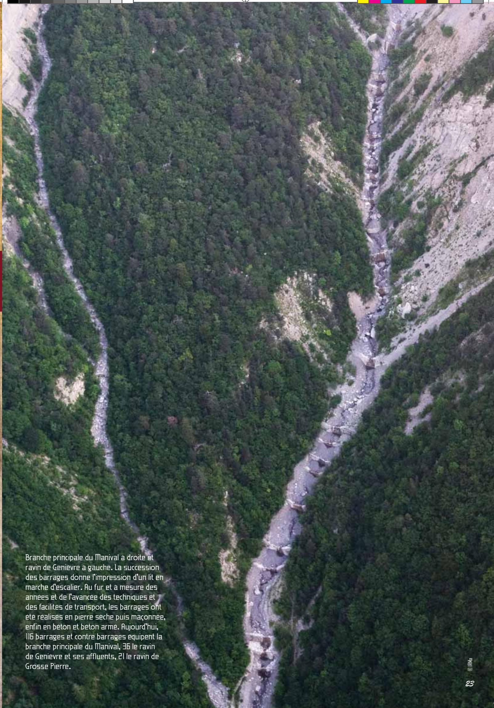
Branche principale du Manival à droite et ravin de Genièvre à gauche. La succession des barrages donne l'impression d'un lit en marche d'escalier. Au fur et à mesure des années et de l'avancée des techniques et des facilités de transport, les barrages ont été réalisés en pierre sèche puis maçonnée, enfin en béton et béton armé. Aujourd'hui, 116 barrages et contre barrages équipent la branche principale du Manival, 36 le ravin de Genièvre et ses affluents, 21 le ravin de Grosse Pierre.
