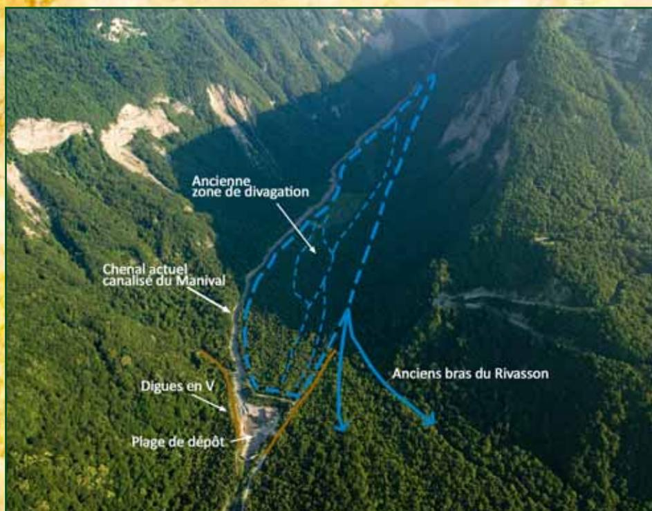
Le volume curé dans la plage de dépôt s'élève en moyenne à 2 200 m<sup>3</sup>/an sur les 25 dernières années (avec un maximum de 7 000 m<sup>3</sup> en 2009) ; cela correspond à une érosion de 2 mm/an du bassin de réception du torrent, si on omet les autres apports, le transit en aval de la plage et surtout les variations de stock dans les ravines et le chenal...
