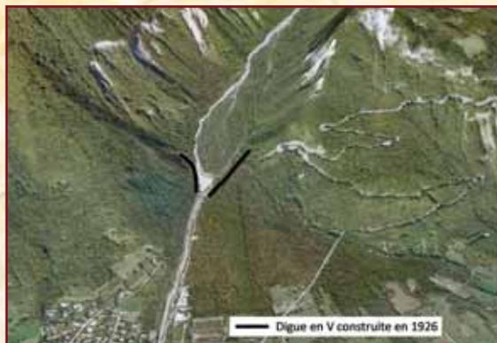
La plage de dépôt limitée par deux digues latérales en V devait permettre de mettre fin aux débordements latéraux, en particulier à partir des diverses branches du Rivasson et de limiter, en les régulant, les apports vers l'aval. C'est un des premiers ouvrages du genre.
