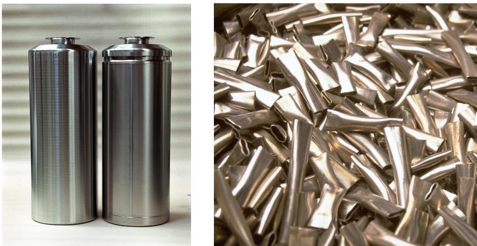
Figure 16 - A gauche : colis de déchets vitrifiés (HA). A droite : déchets de structure du combustible use avant conditionnement (MA-VL) © Areva.
