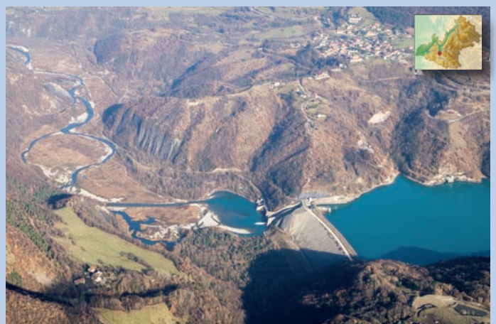
Les eaux du Drac sont retenues par les barrages du Sautet, de Saint-Pierre-de-Cognet, de Monteynard-Avignonet et de Notre-Dame-de-Commiers (photo). La quantité d'eau à l'aval est très nettement diminuée : le Drac n'occupe plus qu'une petite partie de son lit naturel
