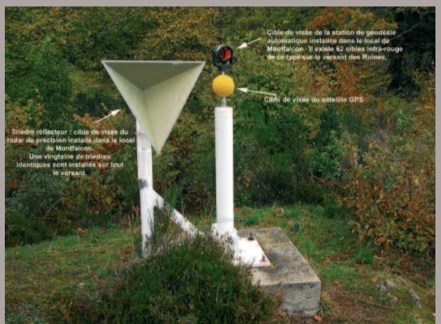
Cibles de visée installées sur le versant des Ruines.
