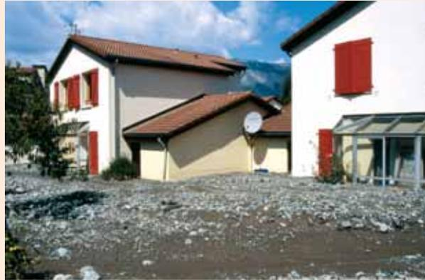
*Engrèvement (environ 1 mètre) des terrains situés juste en aval de la rupture de la digue du torrent du Domeynon - Commune de Domène (38)
