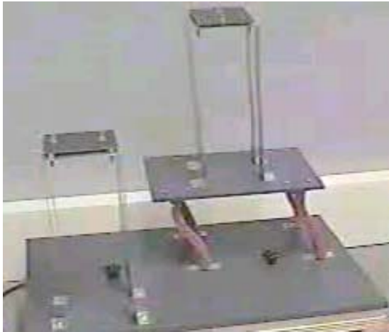
Résonance de la maquette sur appuis en silicone à 100 cycles/minute
