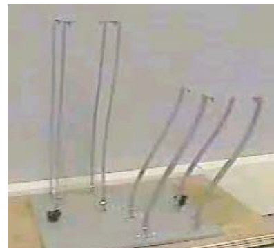
Résonance de la maquette la moins haute à 330 cycles/ minute
