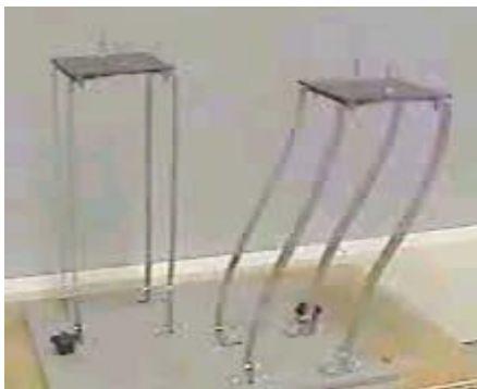
Résonance de la maquette aux poteaux de faible section à 160 cycles/ minute
