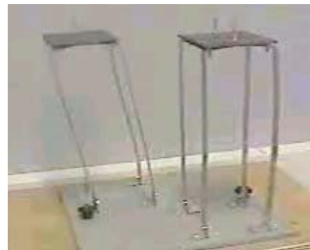
Résonance de la maquette aux poteaux de forte section à 230 cycles/ minute
