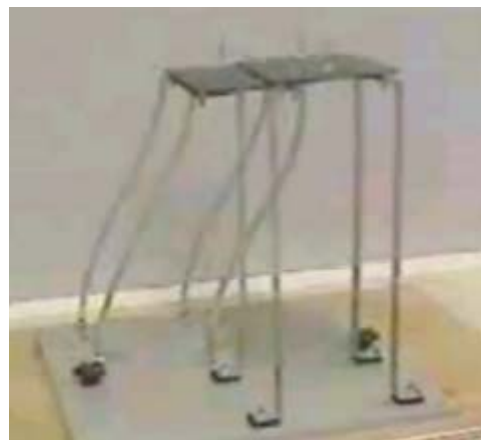
Résonance de la maquette aux liaisons rigides en pied à 170 cycles/ minute
