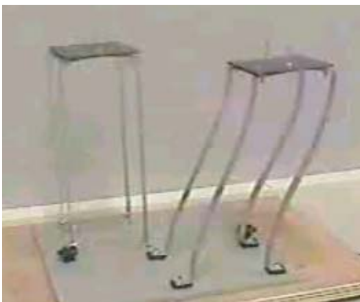
Résonance de la maquette aux liaisons souples en pied à 150 cycles/ minute
