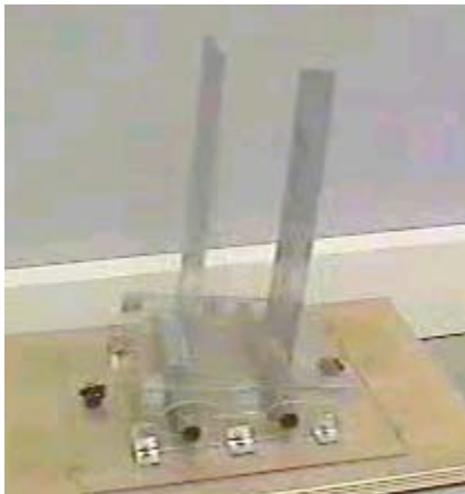
A très basse fréquence, résonance du système "structure + rouleaux"
