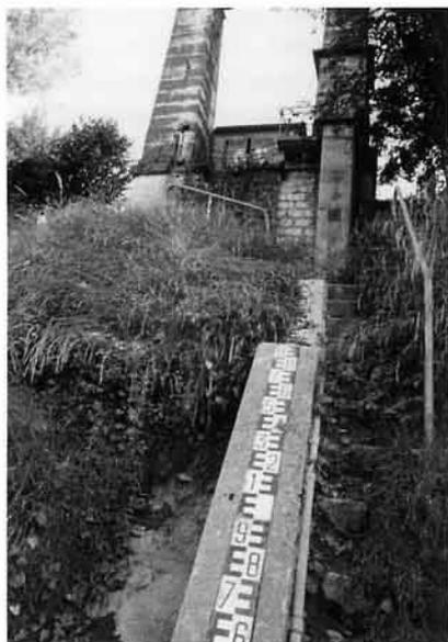
Station hydrométrique de Saint-Gervais avec échelle limnimétrique (mesure de hauteur d'eau)
