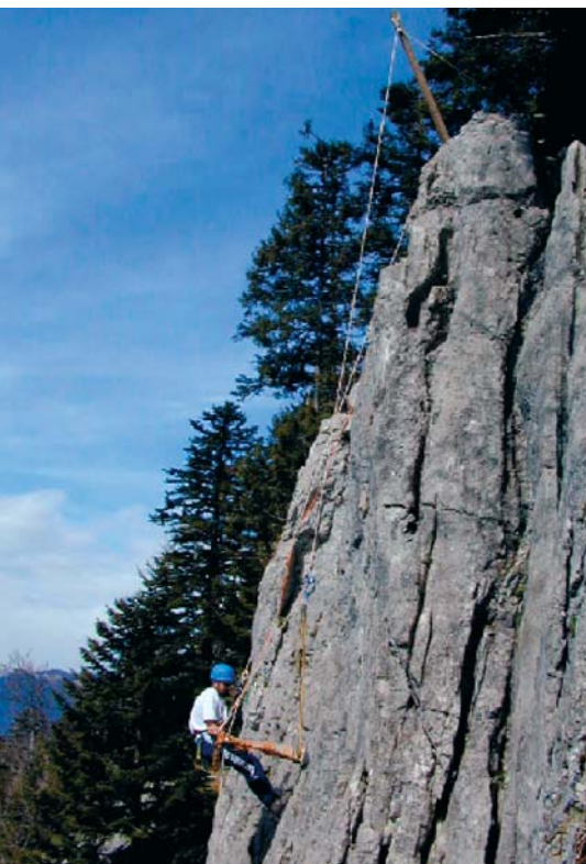
Figure 3. Recherche de fractures ouvertes par la méthode du géoradar.
