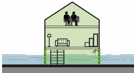
*Principe céder : prévoir l'entrée de l'eau dans le bâtiment puis sa sortie, et surélever les biens et les réseaux.*
