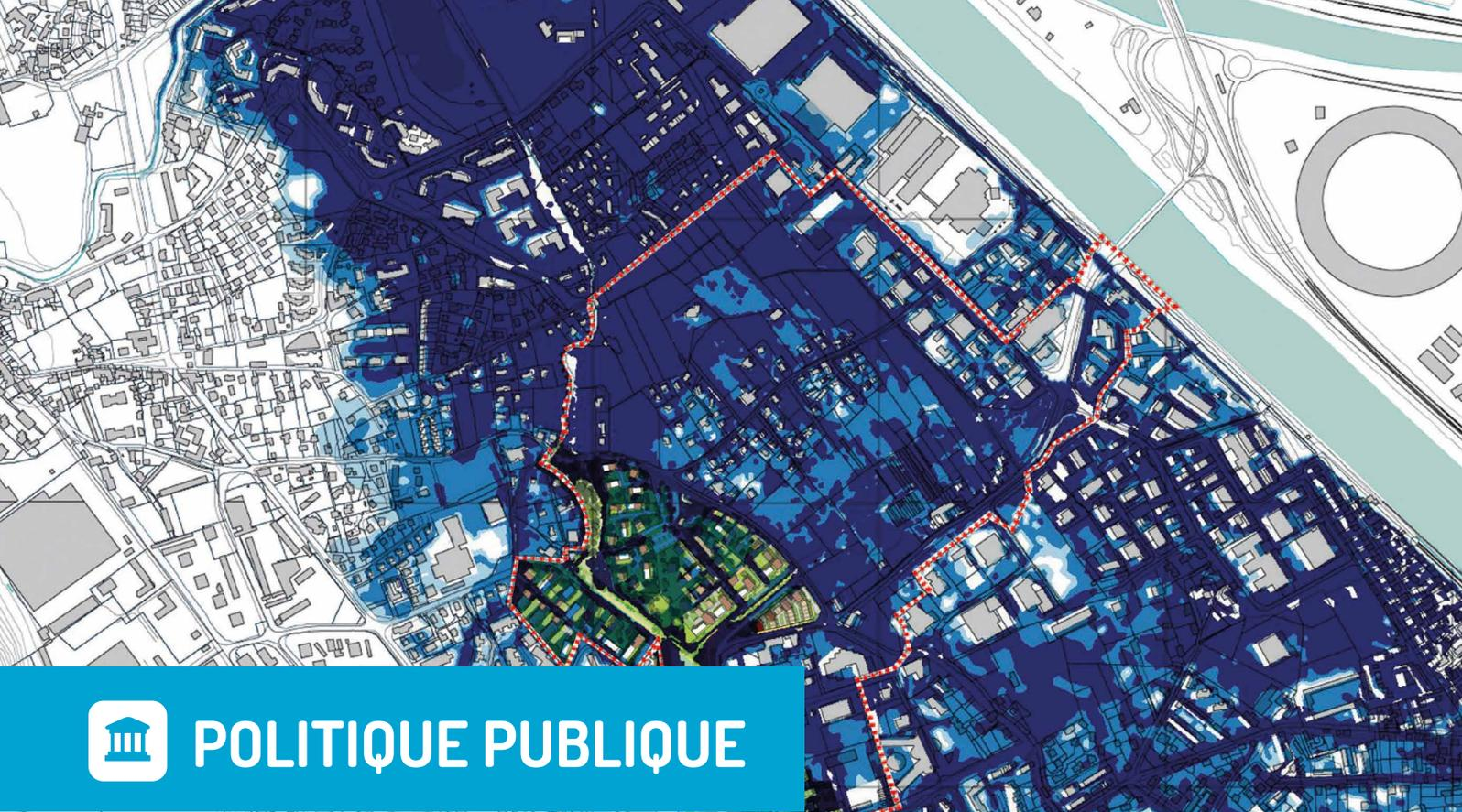
Carte des niveaux d'aléa d'inondation par défaillance des systèmes d'endiguement (rupture de digue) sur le secteur du projet d'aménagement des Portes du Vercors - © Artelia
