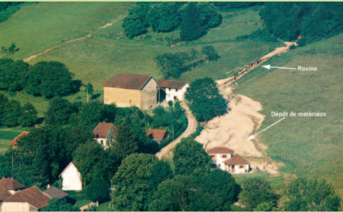
Cormérieu - coteau des Balmettes. Ravinement dans une combe en crue. Engrèvement des terrains alentours et de la voie communale.
